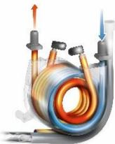
La technologie « Active Temperature Control » garantit une température stable pour des boissons d'exception. Deux systèmes de chauffe indépendants permettent de préparer les boissons café et lactées parfaitement.
