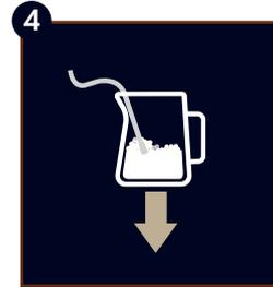
Maintenir la buse vapeur sur la surface, en veillant à ne pas capturer trop d'air en créant des bulles trop grosses.
