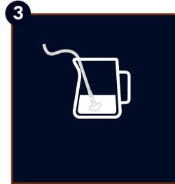
Pour émulsionner le lait, appuyer le tube de la buse à vapeur sur la surface du lait : de cette façon l'air se mélange au lait et à la vapeur.
