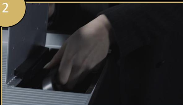
Soulevez le réservoir d'eau pour le sortir de la machine
